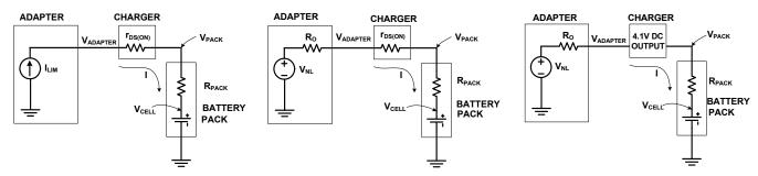
FIGURE 27A. THE EQUIVALENT CIRCUIT IN THE FIGURE 27B. THE EQUIVALENT CIRCUIT IN THE FIGURE 27C. THE EQUIVALENT CIRCUIT WHEN CONSTANT CURRENT REGION RESISTANCE-LIMIT REGION THE PACK VOLTAGE REACHES THE FINAL CHARGE VOLTAGE
