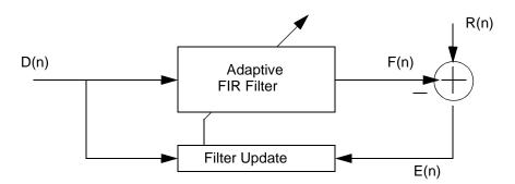
Figure 10-8. Adaptive FIR Filter
